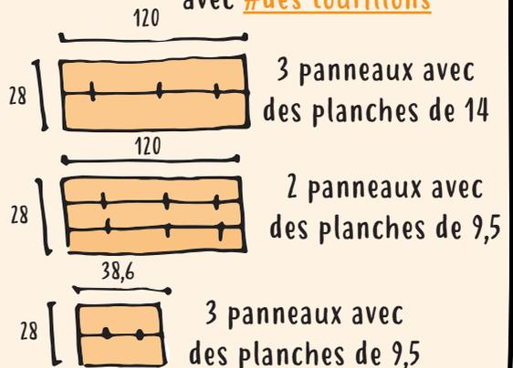
③ Assembler les panneaux en collant et vissant
