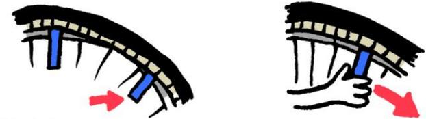
4 - POUR SORTIR LA CHAMBRE À AIR, INUTILE DE SORTIR LE DEUXIÈME FLANC DU PNEU. SORTIR D'ABORD LA VALVE EN LA POUSSANT (ENLEVER BOUCHON ET ÉCROU SI IL Y A) PUIS TIRER SUR LE RESTE.
